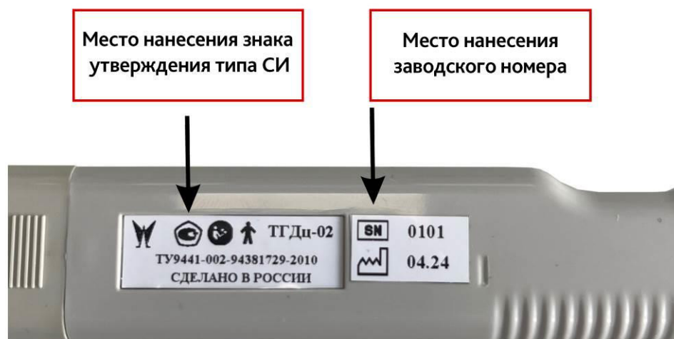
Рисунок 2 – Место нанесения знака утверждения типа и заводского номера
