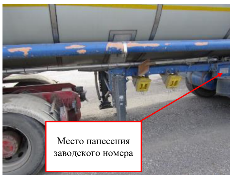
Рисунок 2 – Место нанесения заводского номера полуприцепа-цистерны BURG BRO 13-30Z
