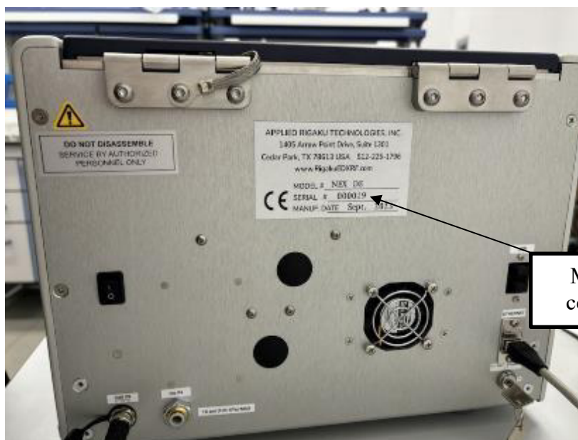
Рисунок 2 – Место нанесения серийного номера на спектрометр рентгенофлуоресцентный энергодисперсионный NEX DE
