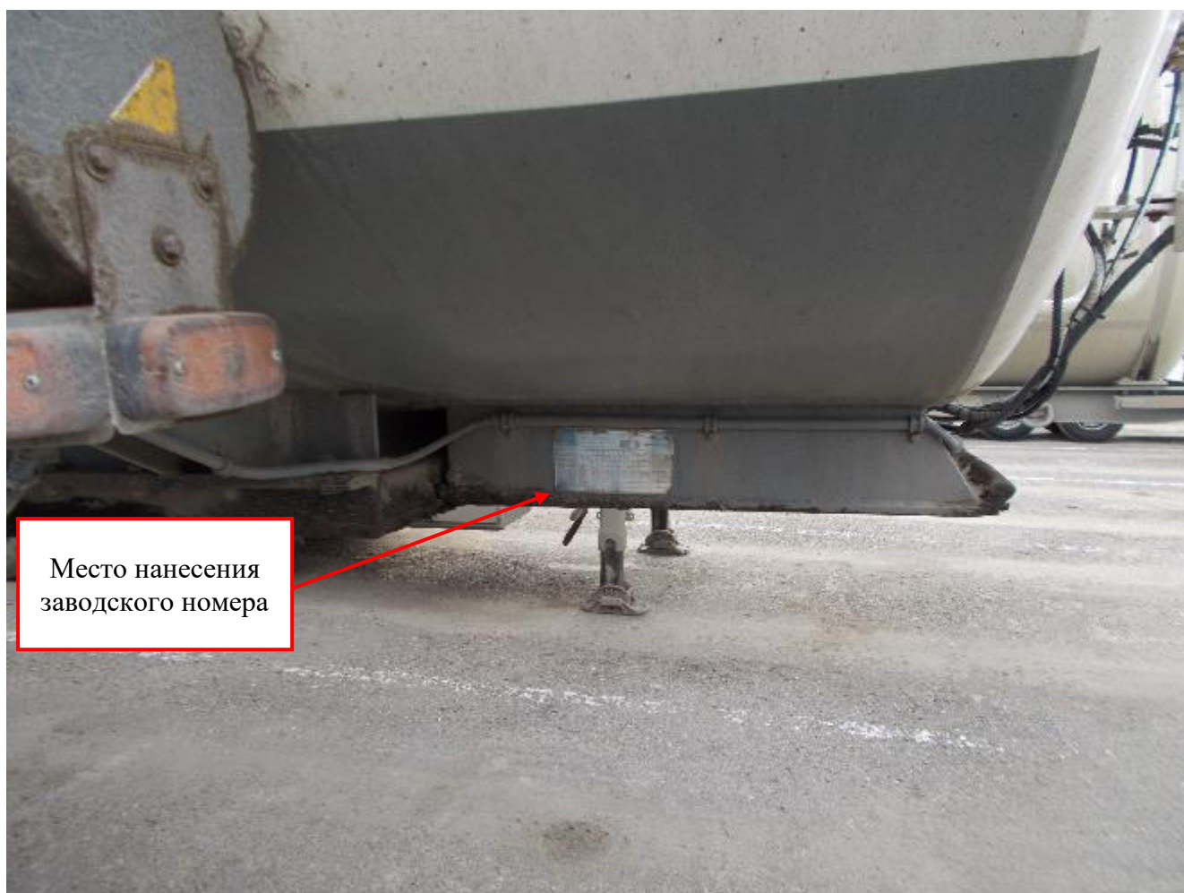
Рисунок 2 – Место установки таблички с заводскими номером на полуприцепе-цистерне DIJSSEL VD42150AL
