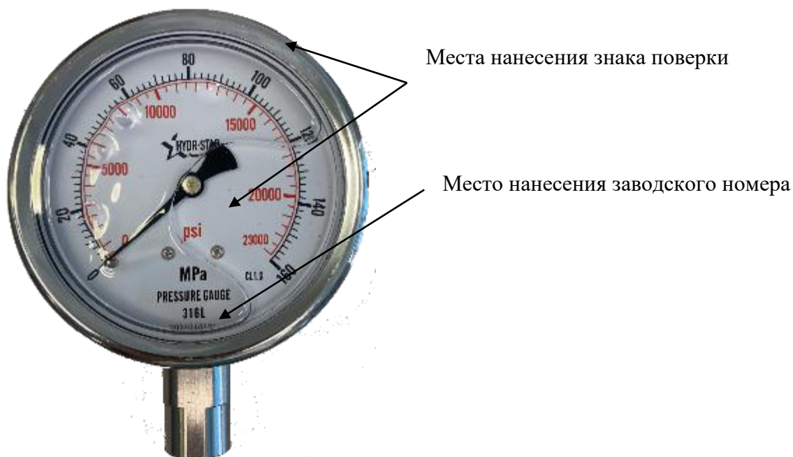
Рисунок 2 – Места нанесения заводского номера и знака поверки
