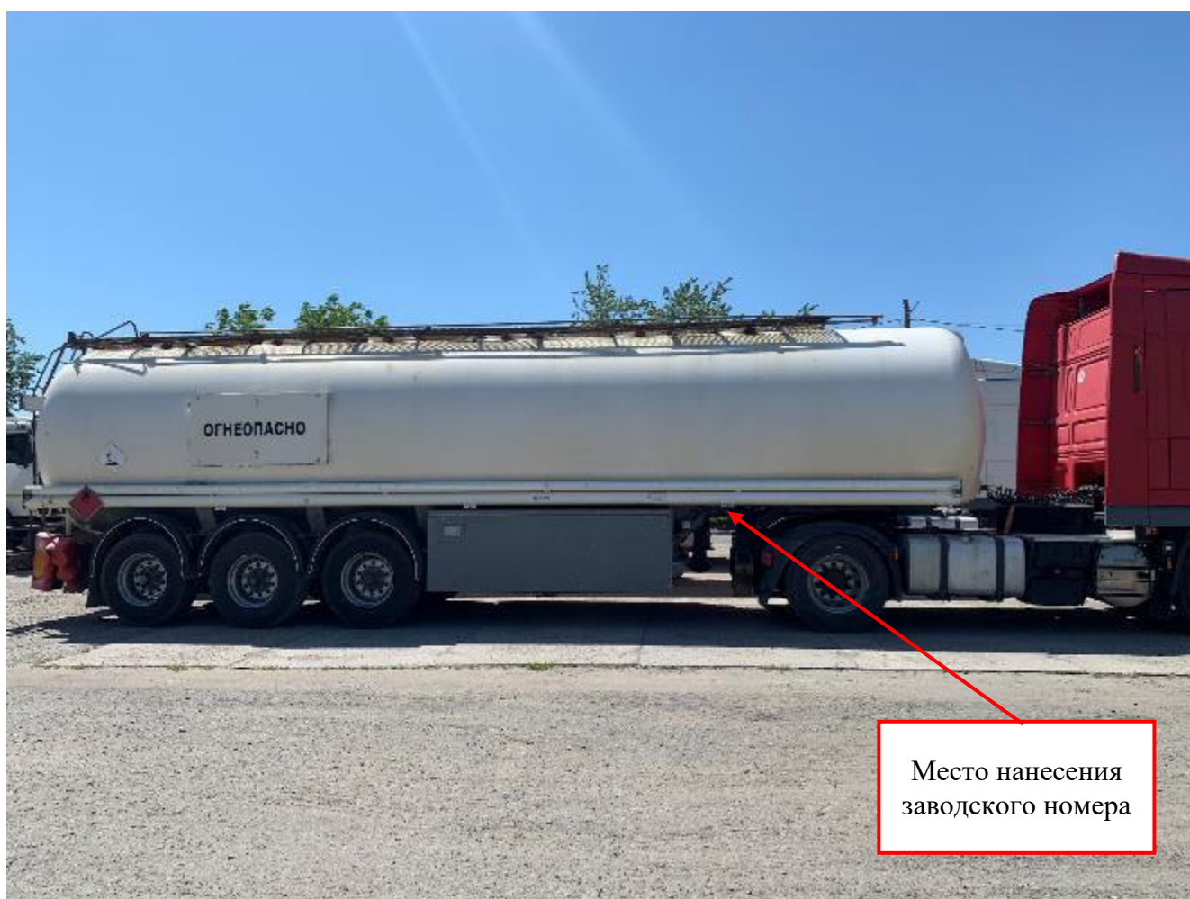
Рисунок 1 – Общий вид полуприцепа-цистерны SCHRADERZ-STA 24-42.6/2 с заводским номером W09SM1334Y1S82652 с указанием места нанесения заводского номера
