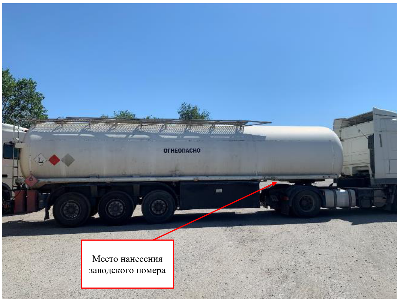
Рисунок 2 – Общий вид полуприцепа-цистерны SCHRADERZ-STA 24-42 7/5 с заводским номером W09SM1334Y1S82691 с указанием места нанесения заводского номера
