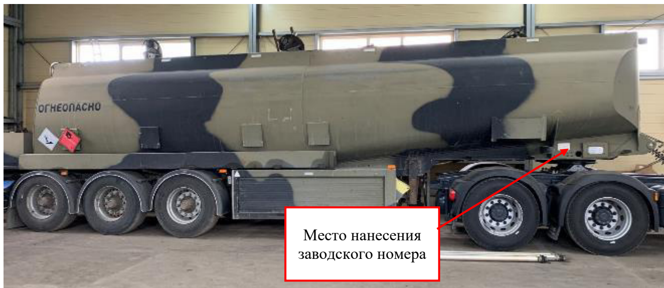
Рисунок 1 – Общий вид полуприцепов-цистерн THOMPSON CARMICHAEL PT44/3 с заводскими номерами SA9PT443001056606, SA9PT443001056357 с указанием места нанесения заводского номера
