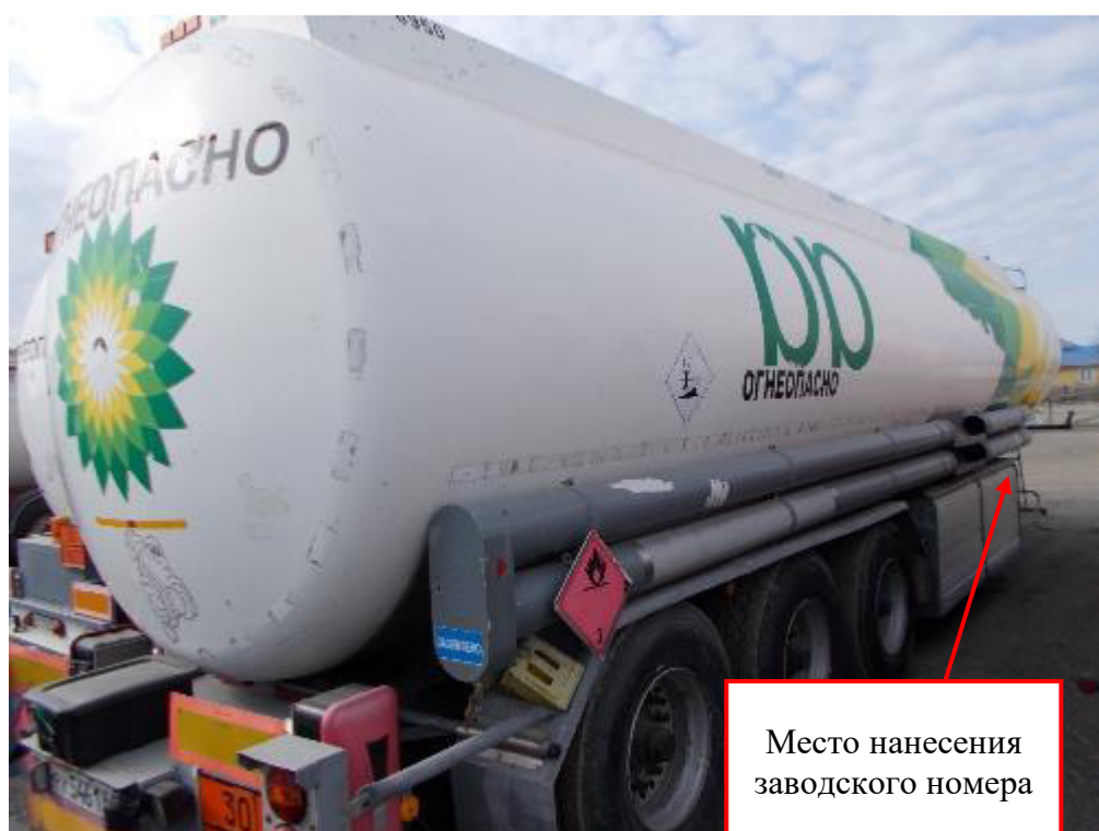
Рисунок 2 – Общий вид полуприцепа-цистерны LAG 0-3-43P с заводским номером 92346 с указанием места нанесения заводского номера
