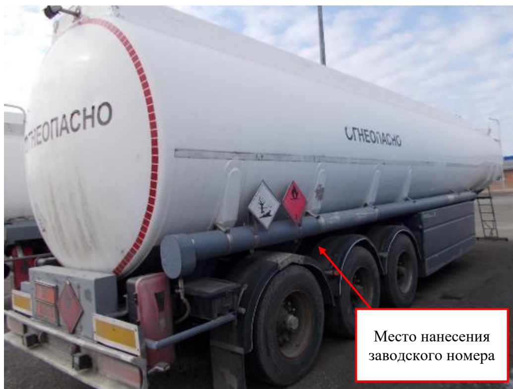
Рисунок 9 – Общий вид полуприцепа-цистерны LAG 0-3-43РТ с заводским номером, YB4L0223430007095 с указанием места нанесения заводского номера
