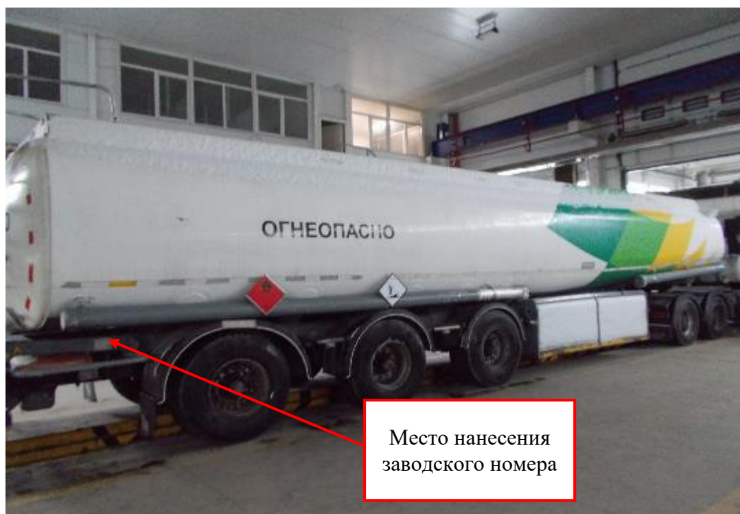
Рисунок 13 – Общий вид полуприцепа-цистерны LAG 0-3-43 5SK с заводским номером YB403435SK9595271 с указанием места нанесения заводского номера
