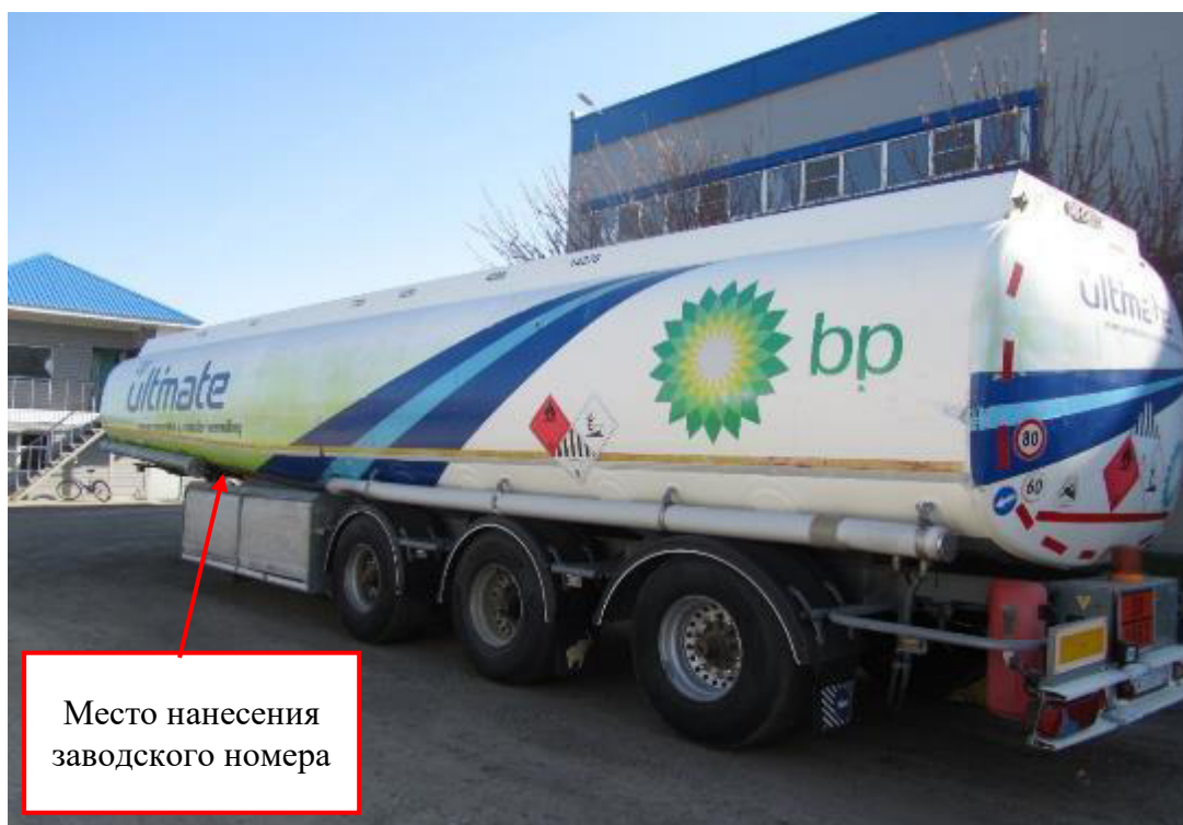
Рисунок 5 – Общий вид полуприцепов-цистерн LAG с заводскими номерами YB403435SK9595279, YB403435SK9595274 с указанием места нанесения заводского номера
