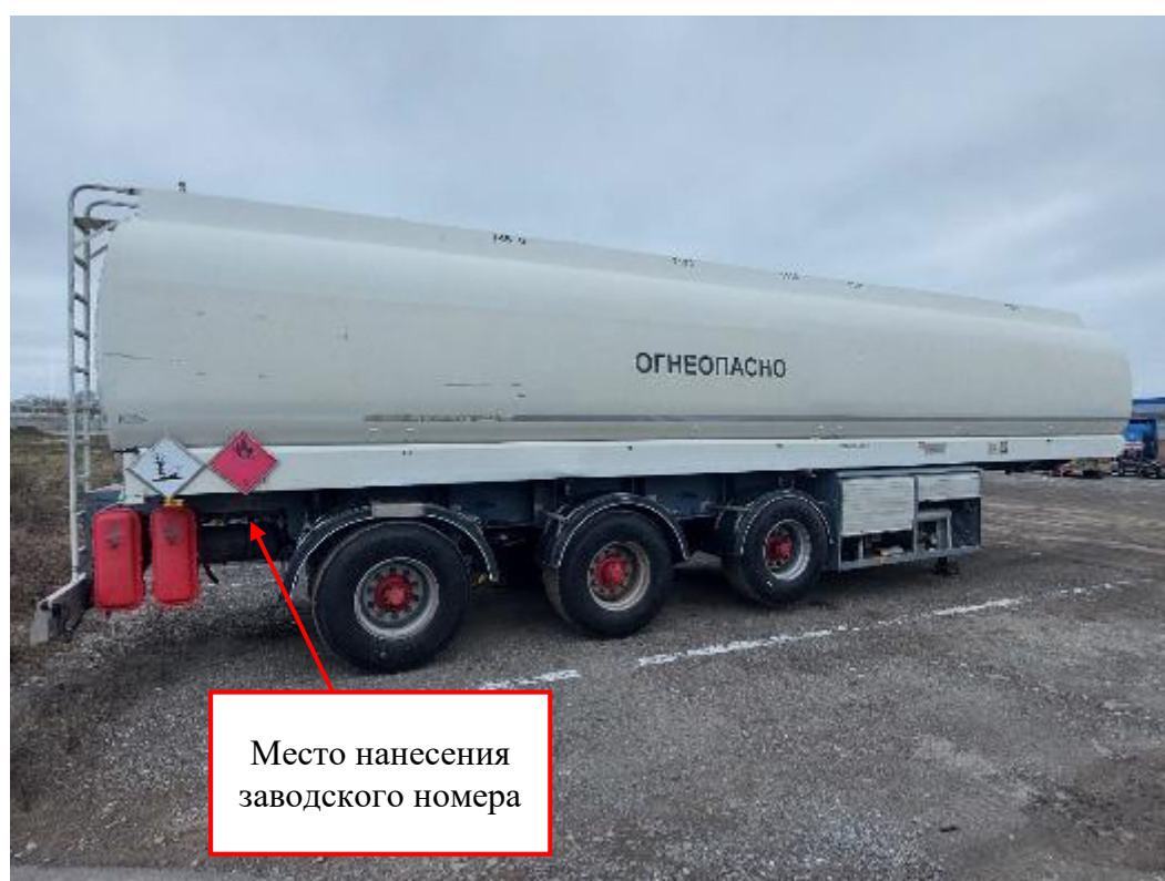
Рисунок 6 – Общий вид полуприцепа-цистерны LAG с заводским номером 93100 с указанием места нанесения заводского номера
