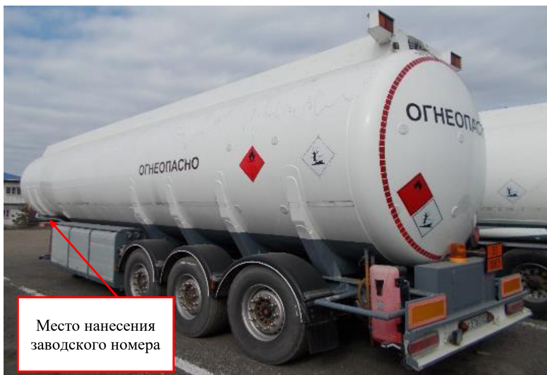
Рисунок 7 – Общий вид полуприцепов-цистерн LAG 0-3-44РТ с заводскими номерами 85146, YB4L0223430210348 с указанием места нанесения заводского номера
