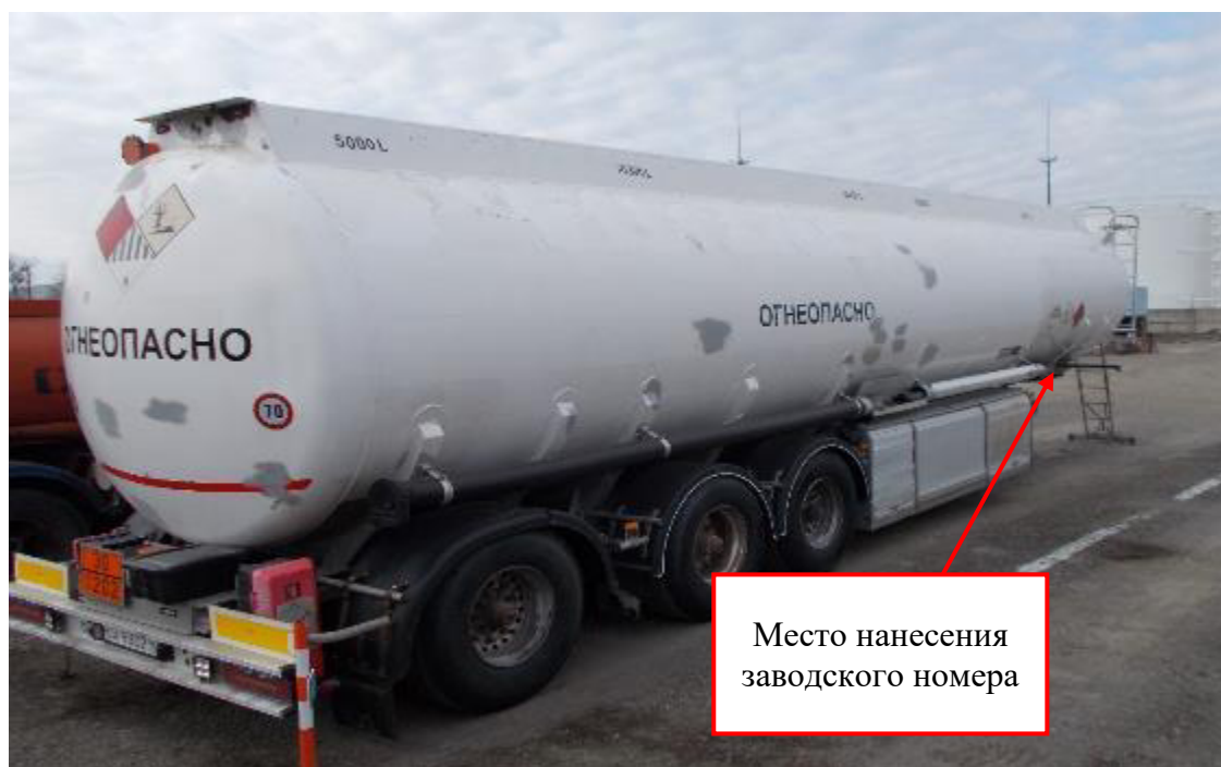
Рисунок 4 – Общий вид полуприцепов-цистерн LAG с заводскими номерами, YB4L0223439801688, YB4L0223439902432, YB4L223430801690 с указанием места нанесения заводского номера
