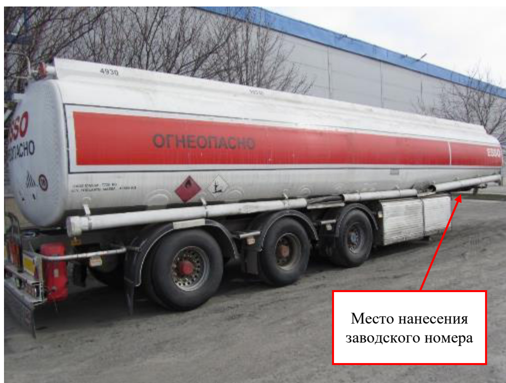
Рисунок 14 – Общий вид полуприцепа-цистерны LAG 0-3-43 5SK с заводским номером 94229 с указанием места нанесения заводского номера
