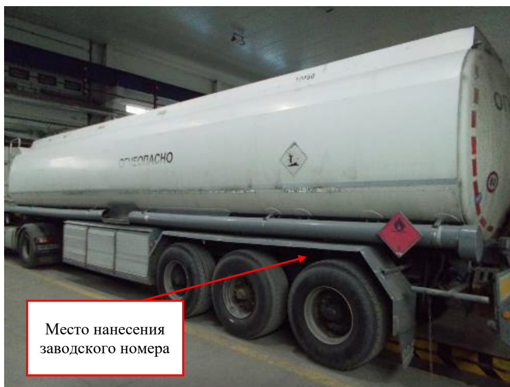
Рисунок 1 – Общий вид полуприцепов-цистерн LAG 0-3-43P с заводскими номерами 91295, 92235, 90022 с указанием места нанесения заводского номера
