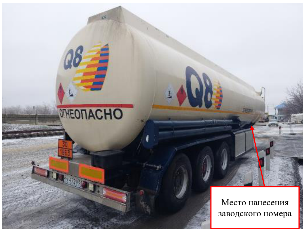
Рисунок 3 – Общий вид полуприцепа-цистерны LAG 0-3-43P с заводским номером 93039 с указанием места нанесения заводского номера
