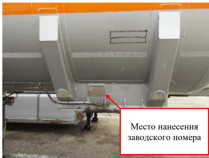
Рисунок 2 – Место нанесения заводского номера полуприцепа-цистерны HENDRICKS TSA 43
