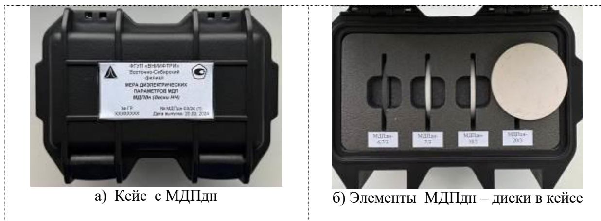
Рисунок 3 – Мера диэлектрических параметров дисков в диапазоне низких частот МДПдн
