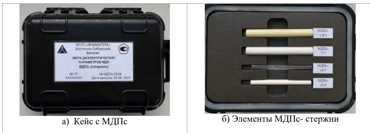
Рисунок 2 – Мера диэлектрических параметров стержней МДПс
