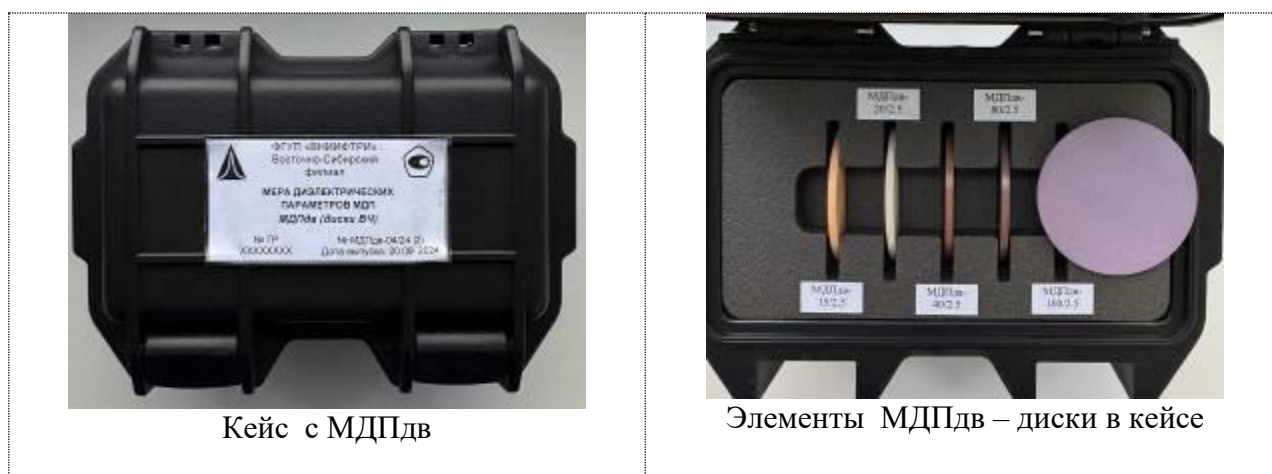
Рисунок 4 – Мера диэлектрических параметров дисков в диапазоне высоких частот МДПдв
