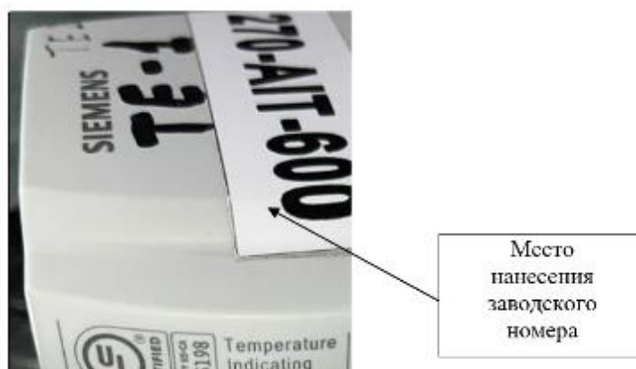
Рисунок 2 – Общий вид датчика с указанием места нанесения заводского номера
