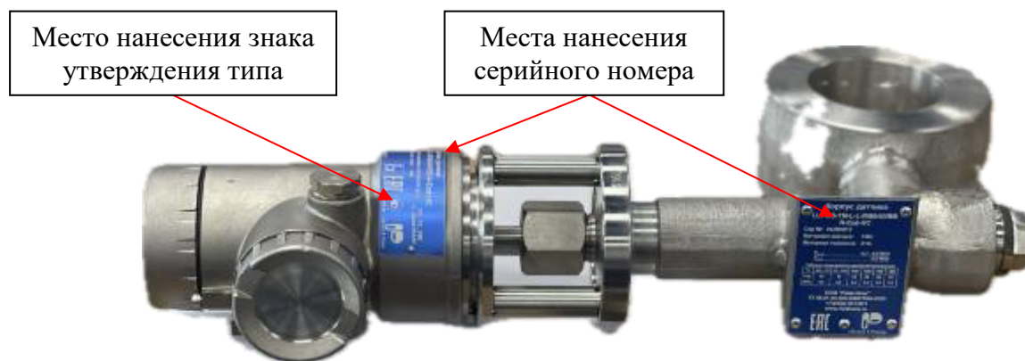
Рисунок 2 – Общий вид датчиков модификаций LLT-DS-TM-X-X-X-X-X-X с указанием мест нанесения знака утверждения типа и серийного номера
