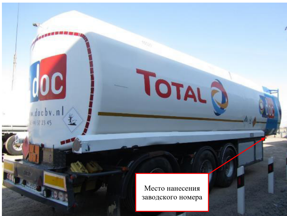
Рисунок 3 – Общий вид полуприцепа-цистерны BURG BPO 13-28 с заводским номером HB2743 с указанием места нанесения заводского номера
