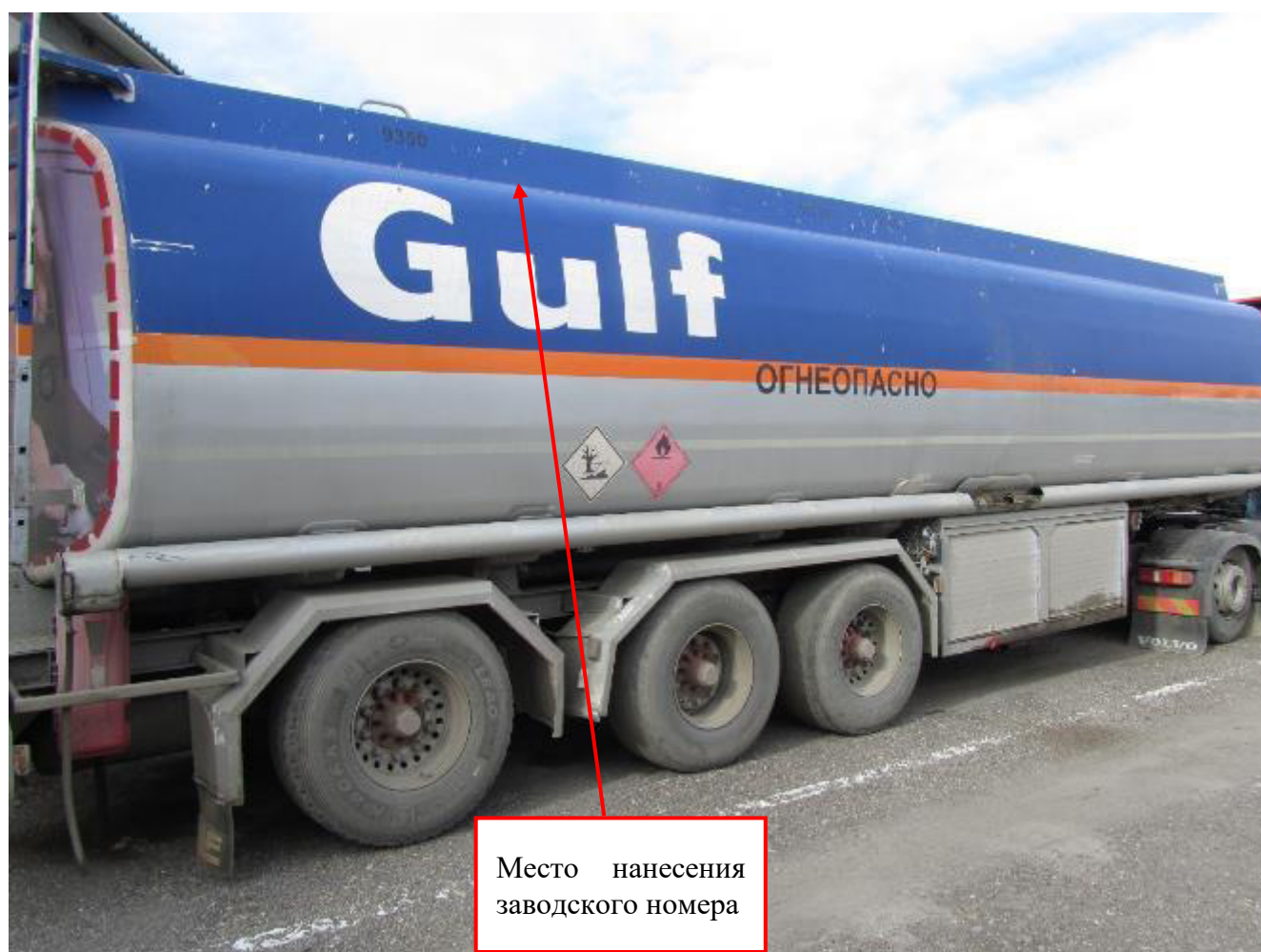
Рисунок 2 – Общий вид полуприцепа-цистерны BURG BPO 13-28 с заводским номером HB2829 с указанием места нанесения заводского номера
