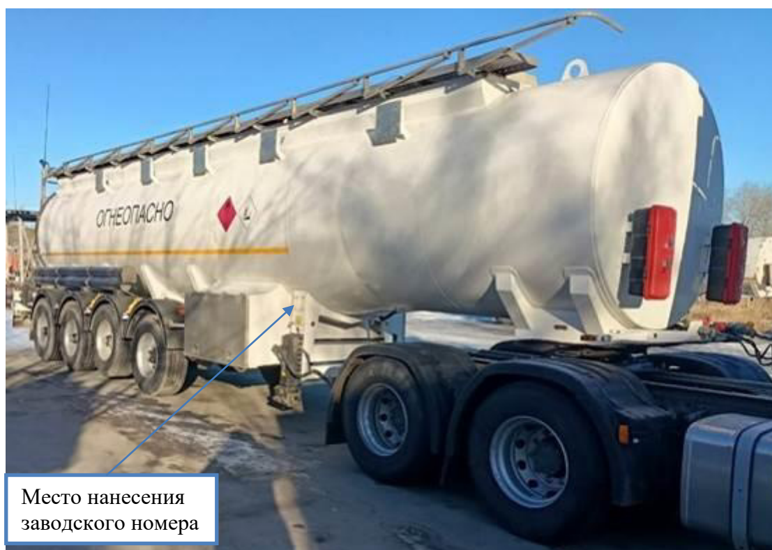
Рисунок 1 – Общий вид полуприцепа-цистерны 9751H5 с указанием места нанесения заводского номера
