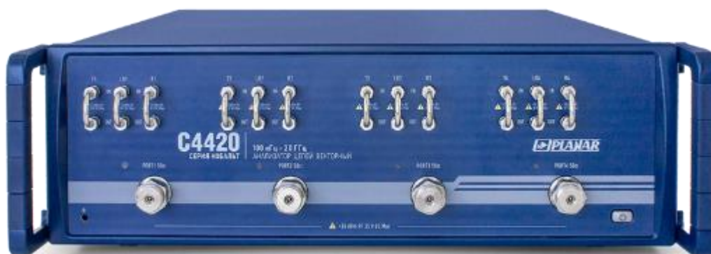
Рисунок 11 – Внешний вида анализатора цепей векторного C4420
