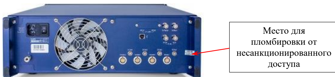
Рисунок 14 – Задняя панель ВАЦ с указанием мест пломбировки от несанкционированного доступа
