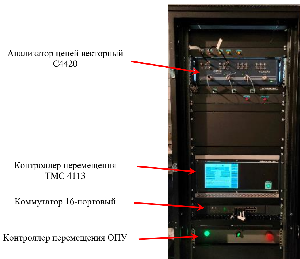
Рисунок 12 – Размещение оборудования в приборной стойке
