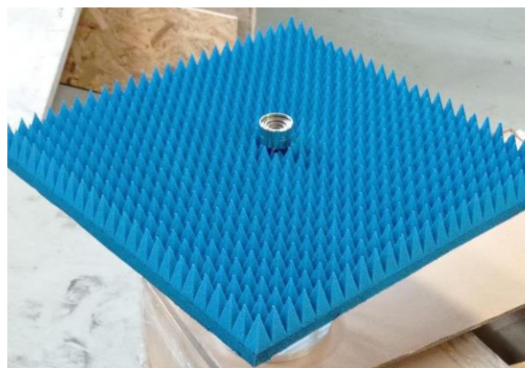
Рисунок 7 – Внешний вид антенны-облучателя ТМО 18.0-26.0
