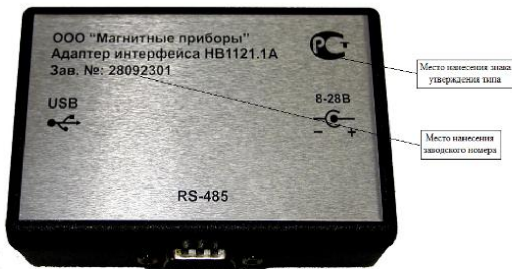
Рисунок 2 – Общий вид первичного измерительного преобразователя НВ1121.1А с указанием мест нанесения знака утверждения типа и заводского номера
