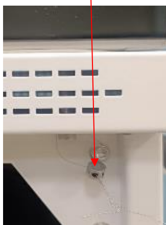
Рисунок 10 – Схема пломбировки корпуса управляющего блока
