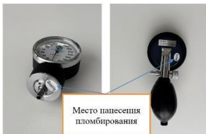
Рисунок 16 – Место нанесения пломбирования от несанкционированного доступа
