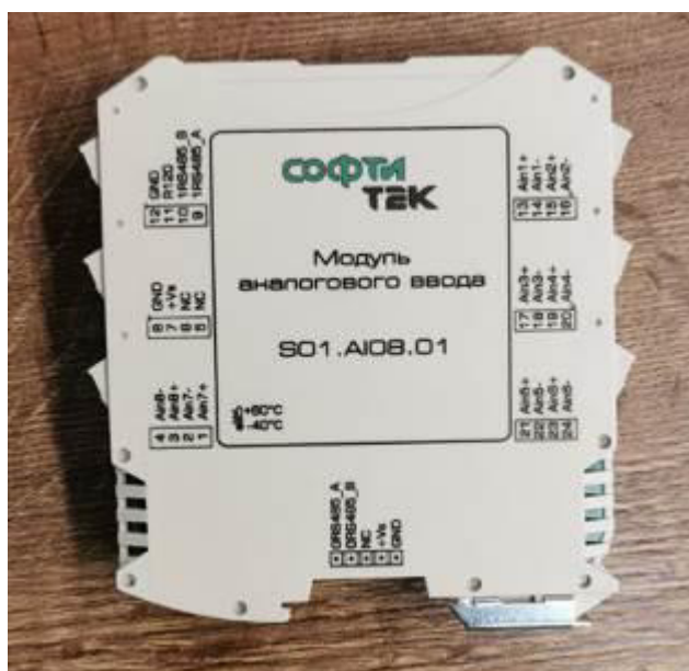
Рисунок 2 – Общий вид модуля аналогового ввода S01.AI08.01
