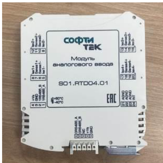
Рисунок 1 – Общий вид модуля аналогового ввода S01.RTD04.01
