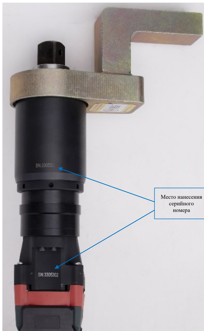
Рисунок 3 – Место нанесения серийного номера гайковертов (прямое исполнение)
