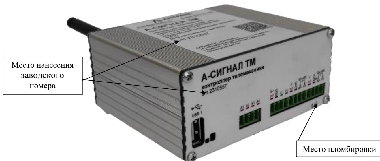
Рисунок 2 – Вид сзади контроллеров с указанием мест нанесения пломбировки и заводского номера
