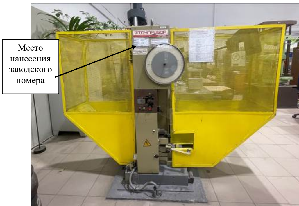
Рисунок 1 – Общий вид копра и место нанесения заводского номера
