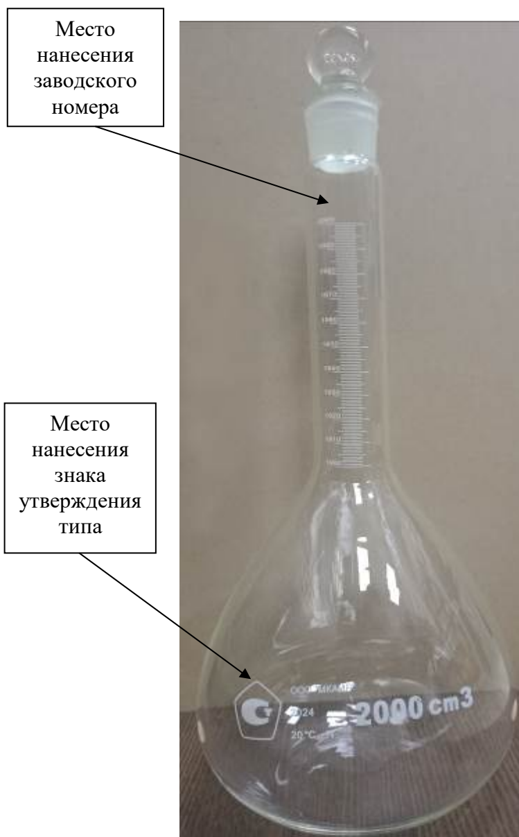
Рисунок 1 – Общий вид колб с указанием мест нанесения знака утверждения типа и заводского номера
