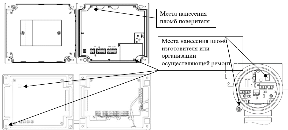
б) варианты пломбировки расходомера-счетчика ультразвукового ЭМИС-УЛЬТРА 290 в зависимости от исполнения электронного блока
