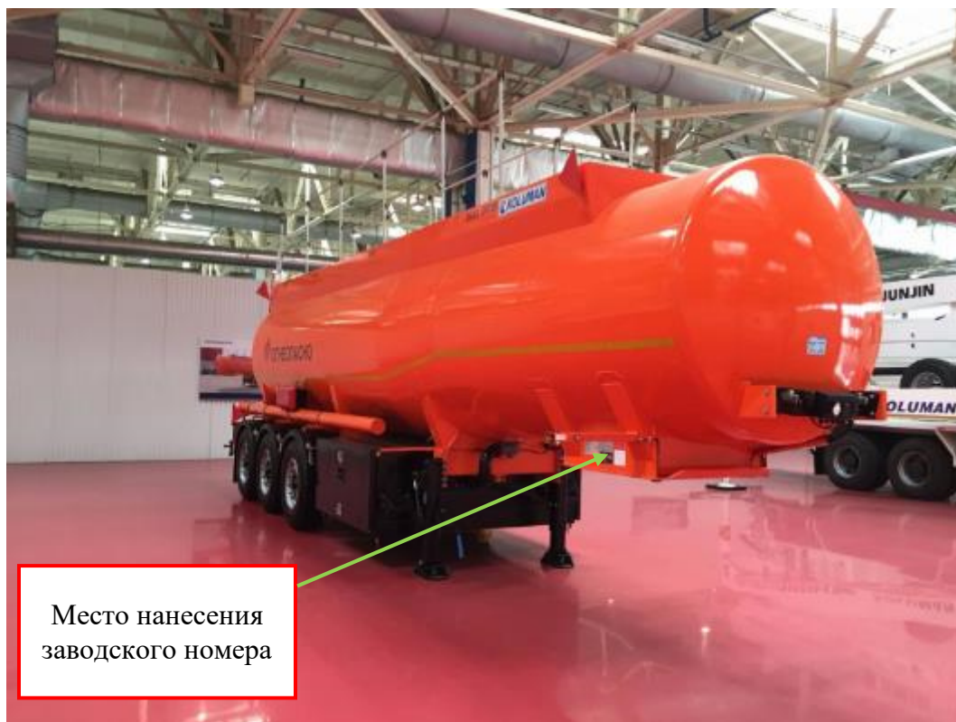
Рисунок 1 – Общий вид полуприцепов-цистерн KOLUMAN-YMTT24 с заводскими номерами NLFY3080000012580 и NLFY3080000012593 с указанием места нанесения заводского номера
