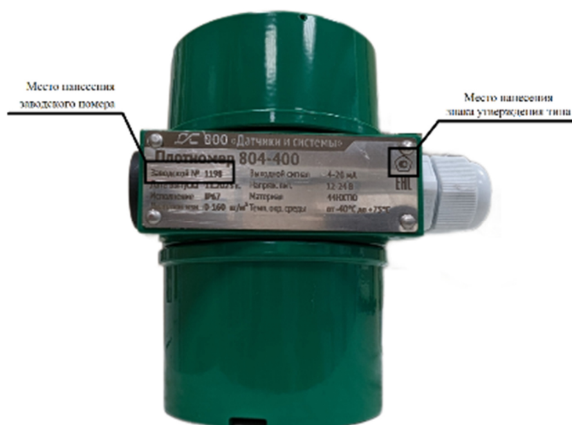
Рисунок 2 – Шильдик с указанием мест нанесения заводского номера, знака утверждения типа
