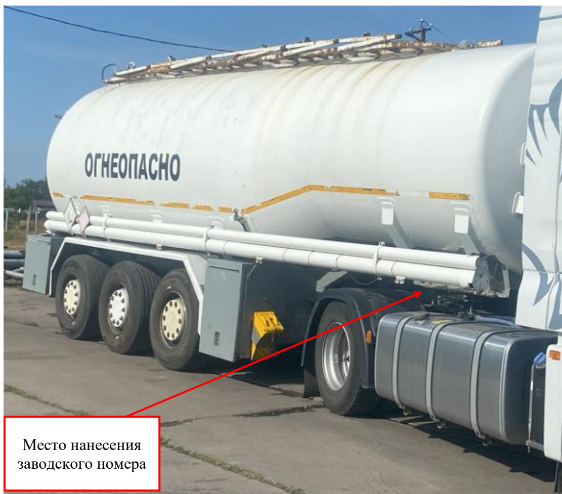
Рисунок 1 – Общий вид полуприцепа-цистерны HENDRICKS GOCH с заводским номером W09G11334XGH46264 с указанием места нанесения заводского номера
