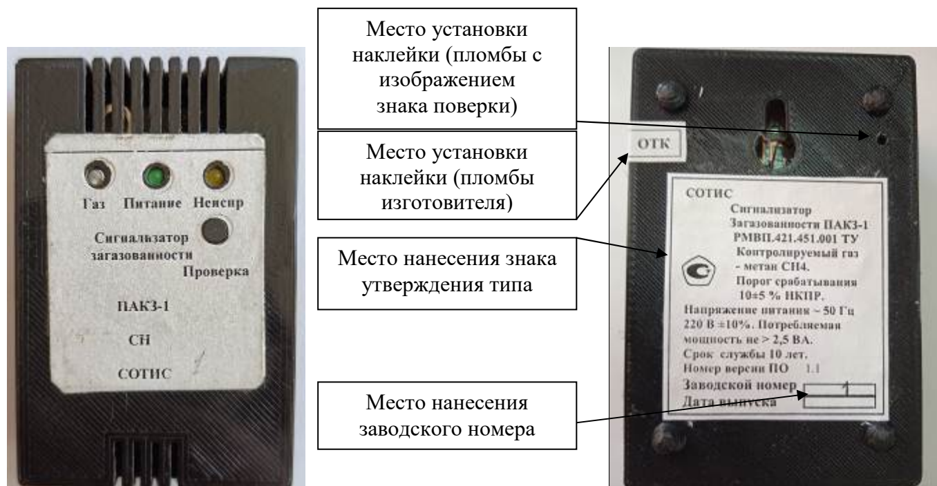
Рисунок 1 – Общий вид сигнализаторов загазованности ПАКЗ-1 с указанием мест пломбирования от несанкционированных действий, места нанесения знака утверждения типа, места нанесения заводского номера
