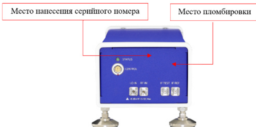
Рисунок 2 – Вид сзади и места нанесения серийного номера, идентифицирующего каждый экземпляр СИ, и схема пломбировки от несанкционированного доступа
