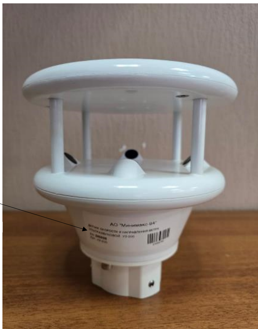
Рисунок 1 – Общий вид датчиков УЗ-200 с указанием места нанесения заводского номера и знака утверждения типа
