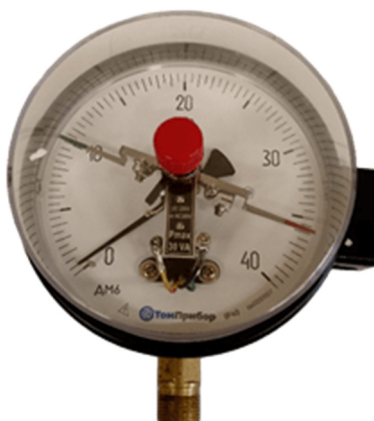
Рисунок 3 – Общий вид манометров показывающих деформационных МТ модификации ДМ с сигнализирующим устройством
