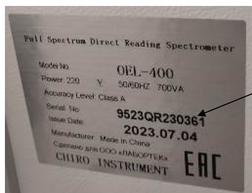
Рисунок 3 – Место нанесения серийного номера спектрометров OEL
