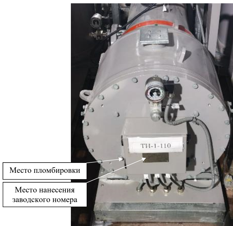
Рисунок 1 – Общий вид средства измерений с указанием места пломбировки, места нанесения заводского номера
