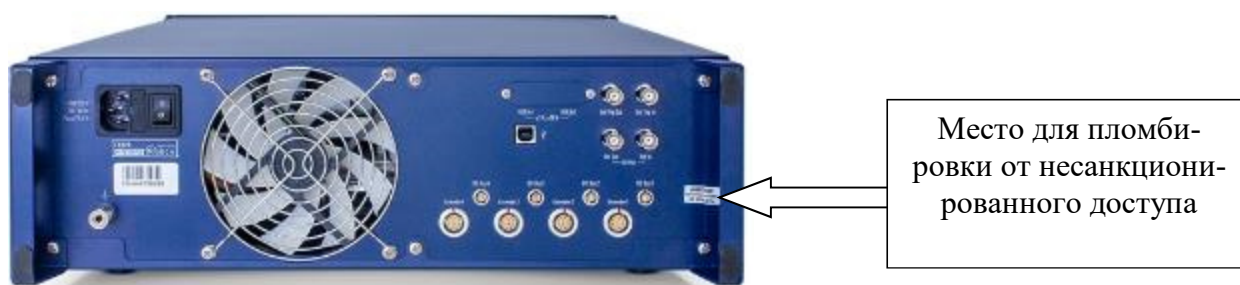
Рисунок 9 – Задняя панель ВАЦ с указанием мест пломбировки от несанкционированного доступа
