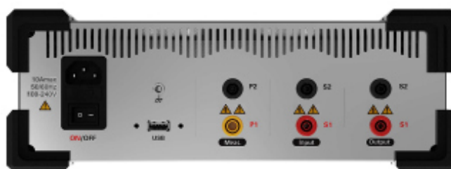
Рисунок 2 – Верхняя панель анализаторов модификации ПТТ200АХ (питание от электрической сети переменного тока)
