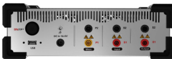
Рисунок 3 – Верхняя панель анализаторов модификации ПТТ200АХ-Б (питание от встроенного аккумулятора)
