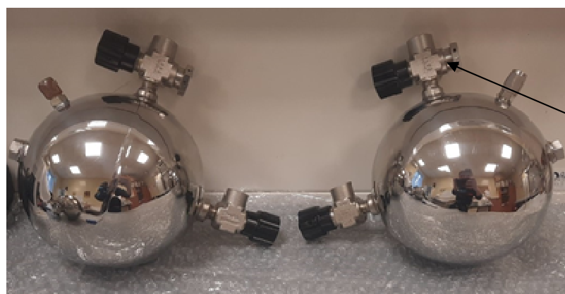
Рисунок 1 – Общий вид пикнометра с указанием места нанесения заводского номера
