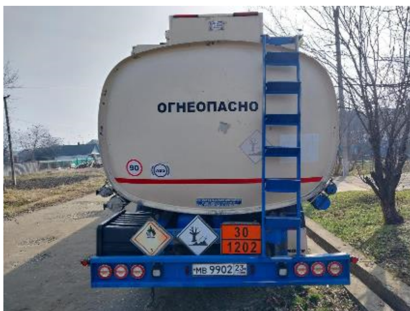
Рисунок 2 – Общий вид полуприцеп-цистерны ACERBI 18K2.39
