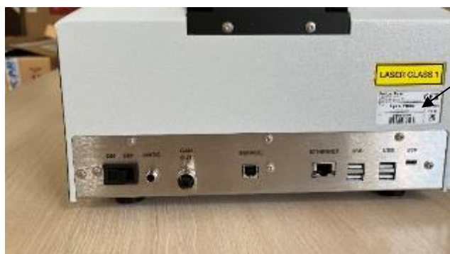
Рисунок 3 – Место нанесения серийного номера на спектрометры инфракрасные с преобразованием Фурье Lyza
