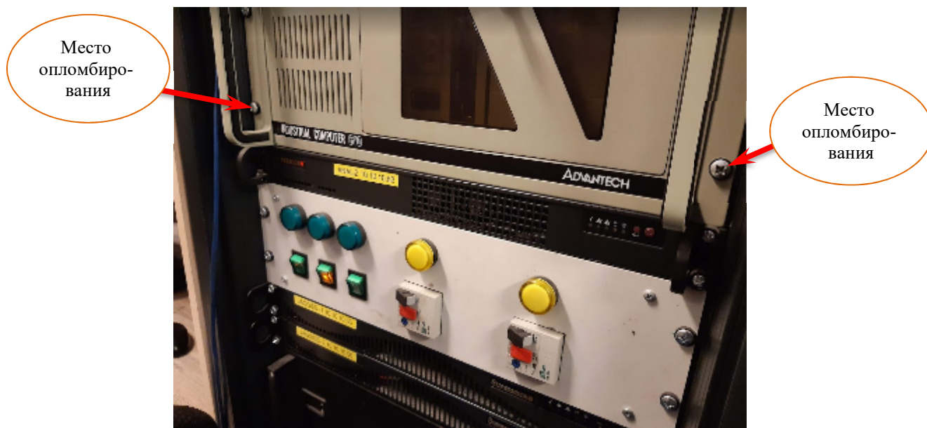
Рисунок 2 – Места пломбирования систем бесконтактных путеизмерительных «АВИТРЕК»
