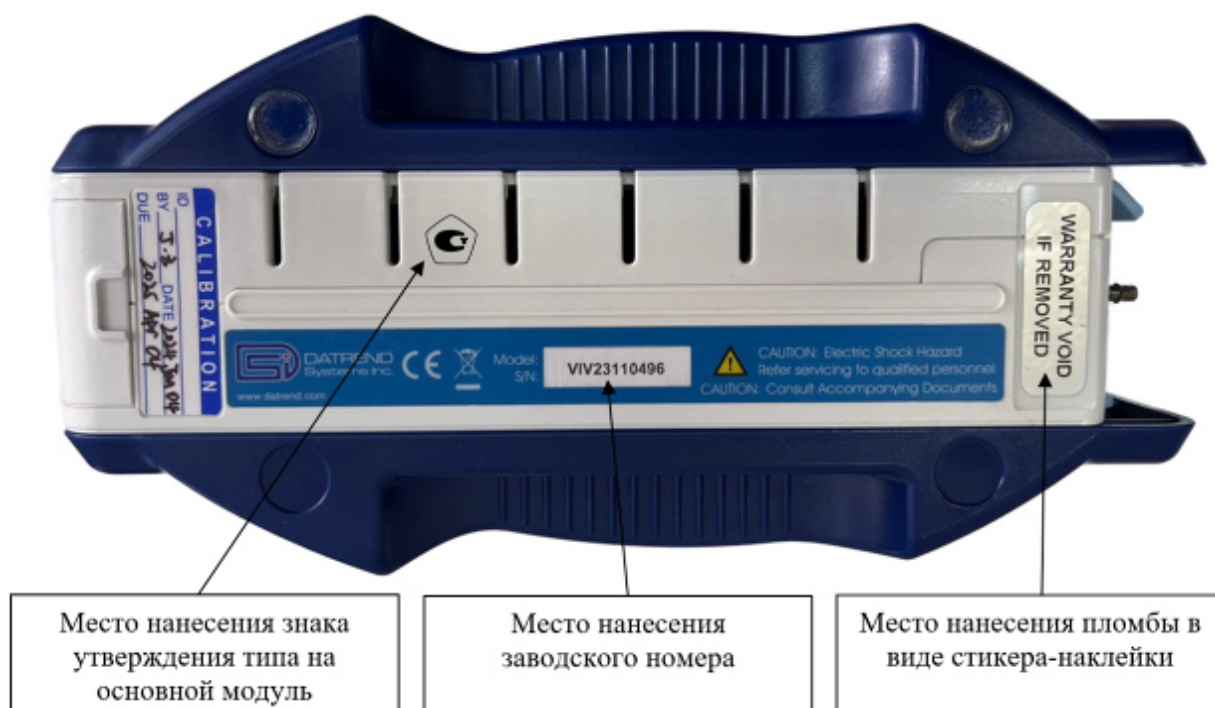
Рисунок 7 – Место нанесения знака утверждения типа (для основного модуля) и заводского номера на нижнюю панель модуля, а также схема пломбировки в целях предотвращения несанкционированной настройки и вмешательства анализаторов инфузионных устройств vPad-IV
