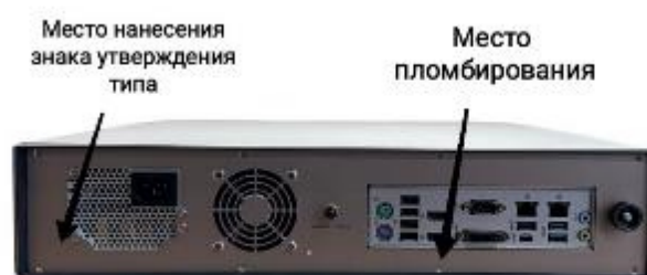
Рисунок 2 – Схема пломбировки и место нанесения знака утверждения типа
