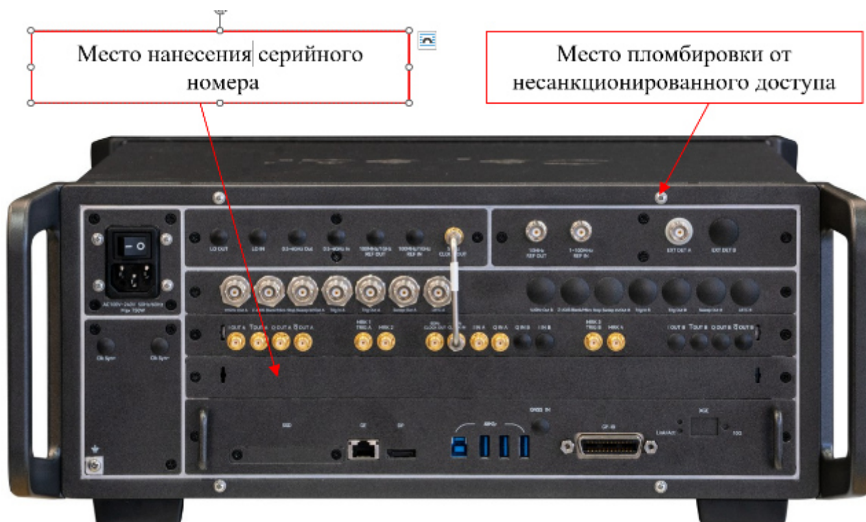
Рисунок 2 – Схема пломбировки от несанкционированного доступа
