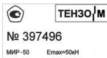
Рисунок 2 – Внешний вид наклейки датчиков МИР.
