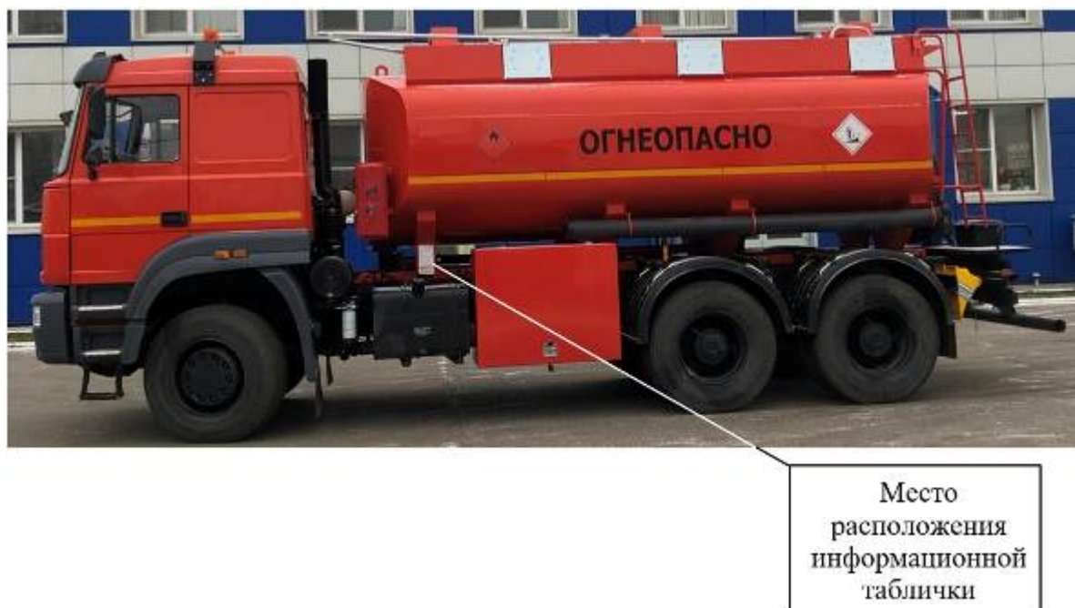
Рисунок 2 – Общий вид автотопливозаправщика АТЗ-15,0 4693Е1 и место расположения информационной таблички
