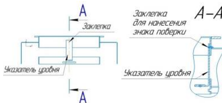
Рисунок 4 – Схема пломбировки от несанкционированного изменения положения указателя уровня налива в горловине цистерны, обозначение места нанесения знака поверки
