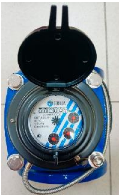
а) счетчик, предназначенный для измерения объема холодной воды (Х)
