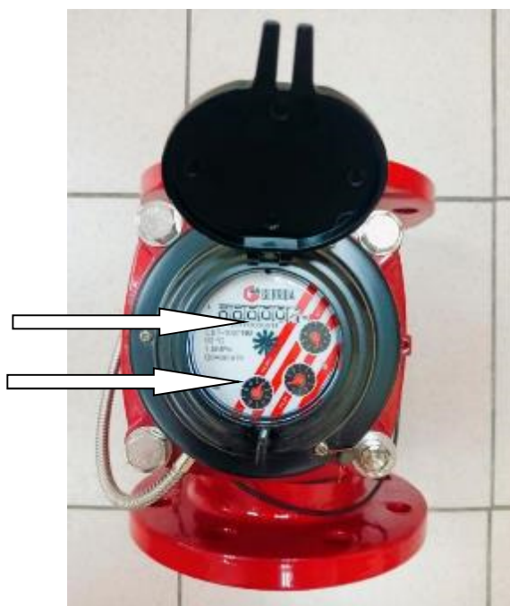
Рисунок 3 – Схема нанесения знака утверждения типа и заводского номера
