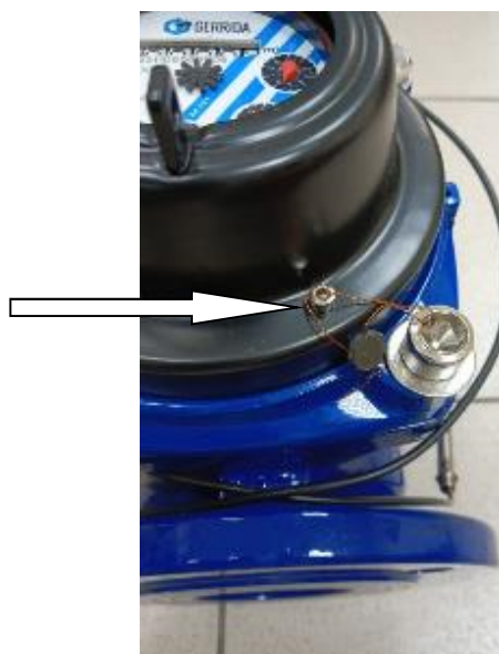
Рисунок 2 – Схема пломбировки от несанкционированного доступа, обозначение места нанесения знака поверки счетчиков
