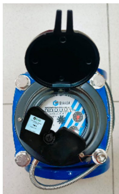
г) счетчики, имеющие внешний электронный модуль, позволяющий передавать значения объема жидкости в потоке в цифровом виде по радиоканалу или проводной линии связи (Д)
