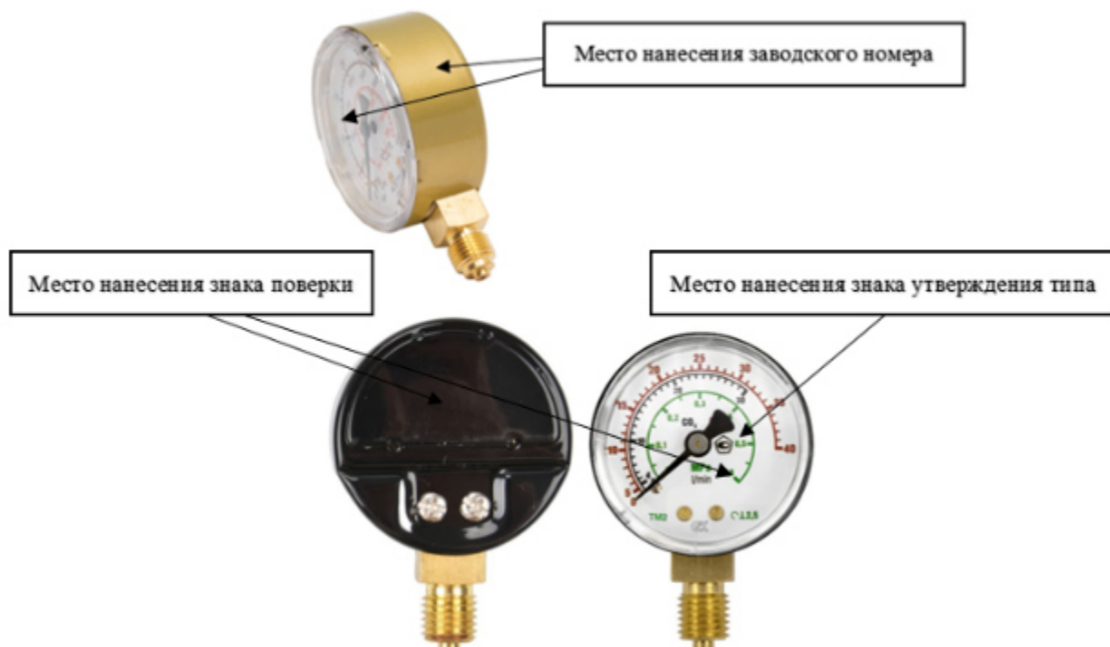
Рисунок 2 – Место нанесения заводского номера, знака поверки и знака утверждения типа
