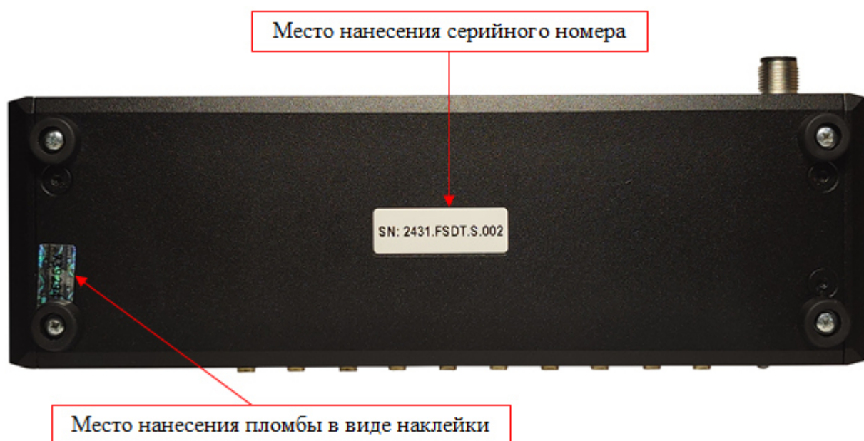
Рисунок 2 – Нижняя панель корпуса устройства частотно-временной синхронизации УЧВС Секунда
