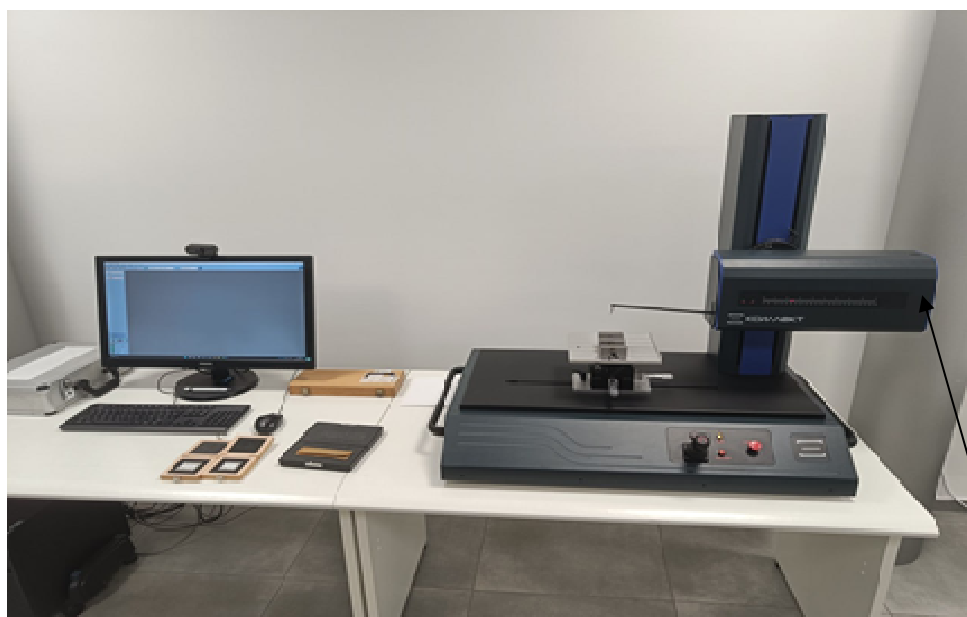
Рисунок 2 – Общий вид приборов для измерений параметров контура поверхности МС 2П-100
