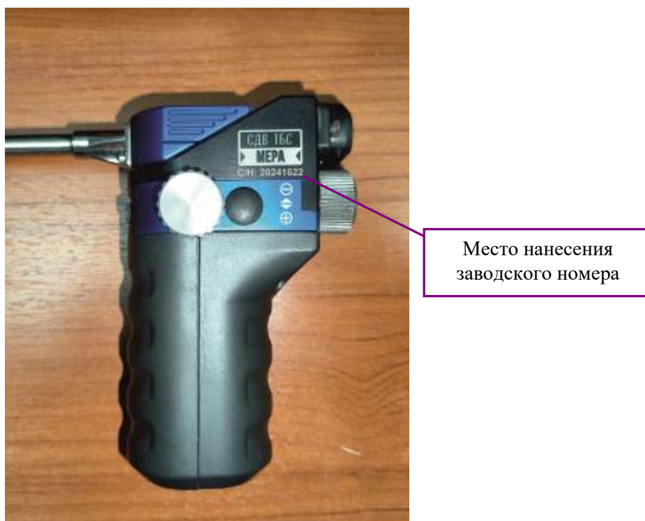
Рисунок 3 – Маркировка держателей для зондов с указанием места нанесения заводского номера
