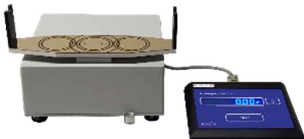
Рисунок 1 – Общий вид модификации компаратора КМ7202. Грузоприёмное устройство для взвешивания пикнометра.
